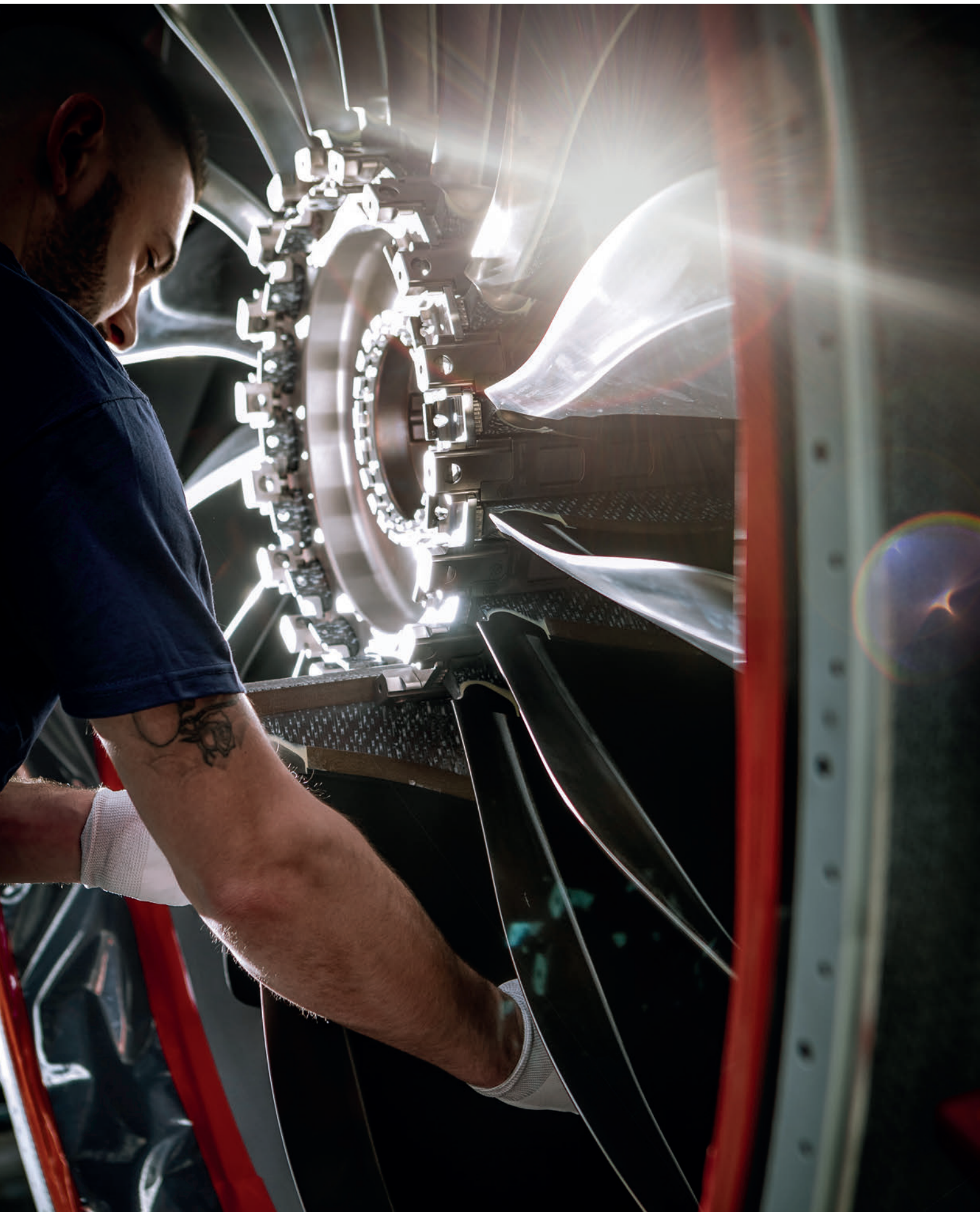
Assemblage des modules du moteur LEAP
