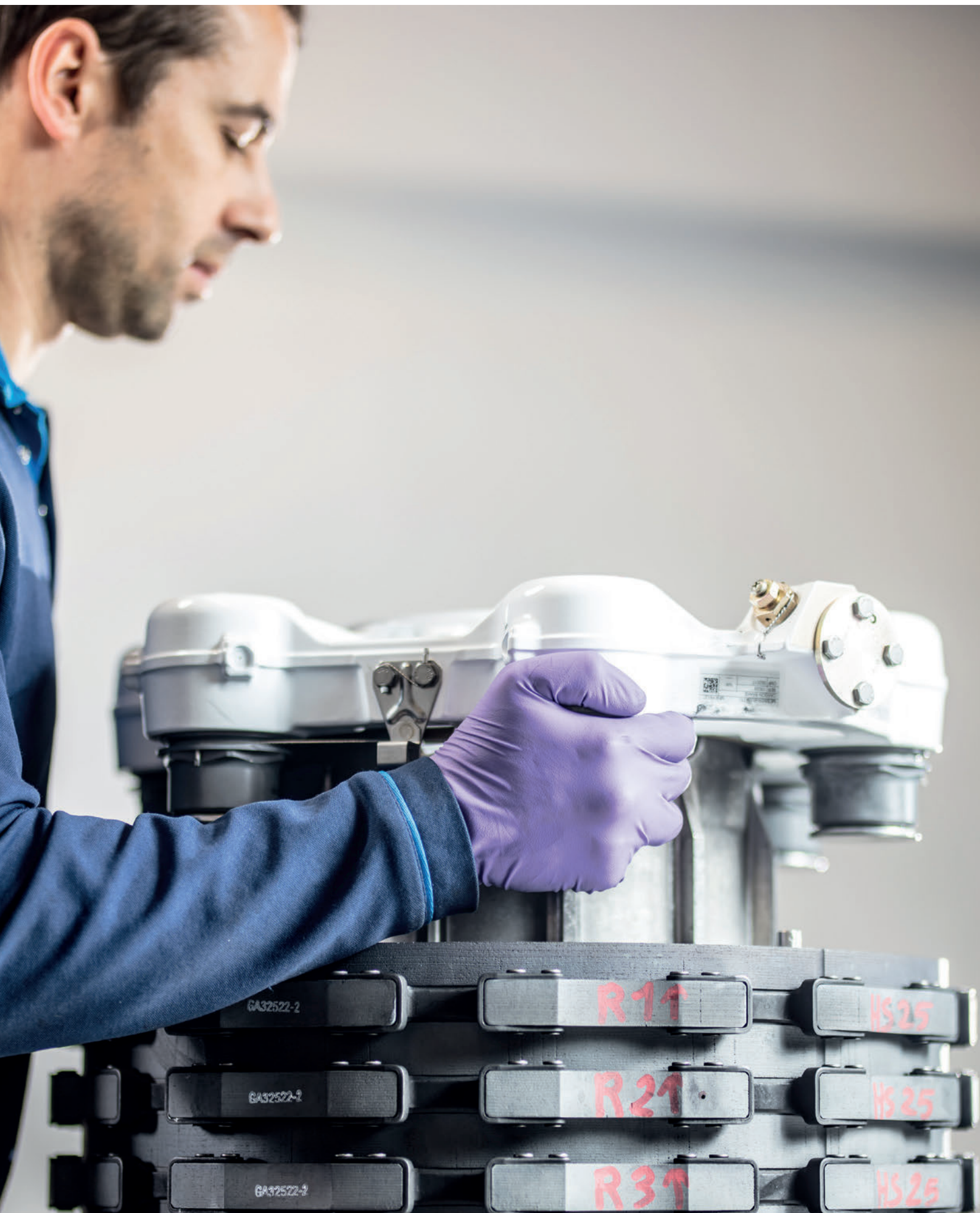
Assemblage des disques carbone pour le frein du 777X
